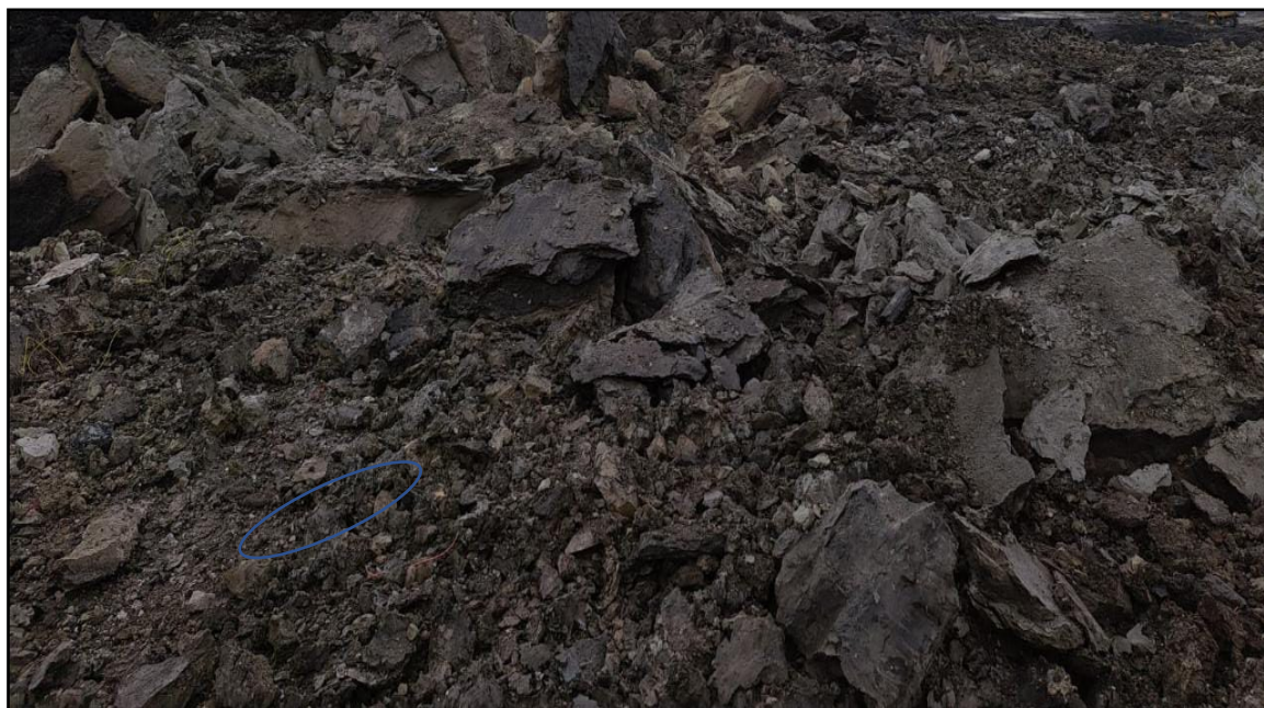
Gambar 5. Pengambilan Foto Kedua Fragmentasi Langsung di Lapangan dengan Kedalaman Stemming 4 meter
