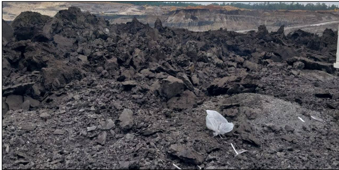
Gambar 2. Pengambilan Foto Pertama Fragmentasi Langsung di Lapangan dengan Kedalaman Stemming 3 meter
