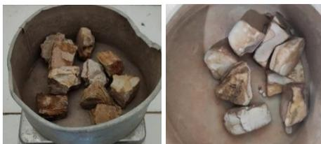
**Gambar 8.** Hasil Pengujian *Durability* Sampel 5
