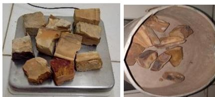
**Gambar 7.** Hasil Pengujian *Durability* Sampel 4
