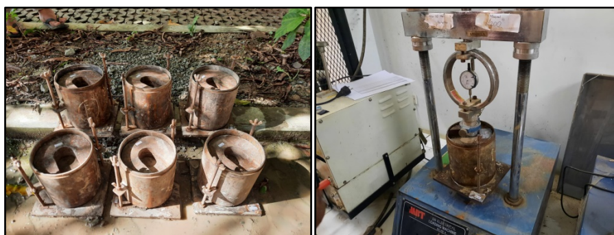
Gambar 3. Pengujian Sampel CBR Laboratorium
