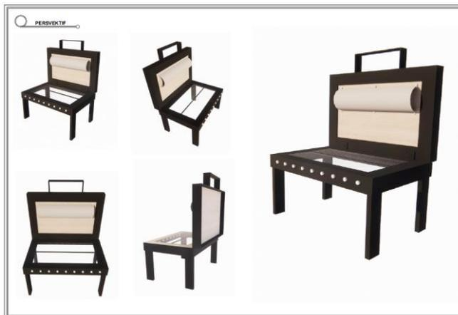
**Gambar 2.** Implementasi Alat Pemotong Adonan Kerupuk
